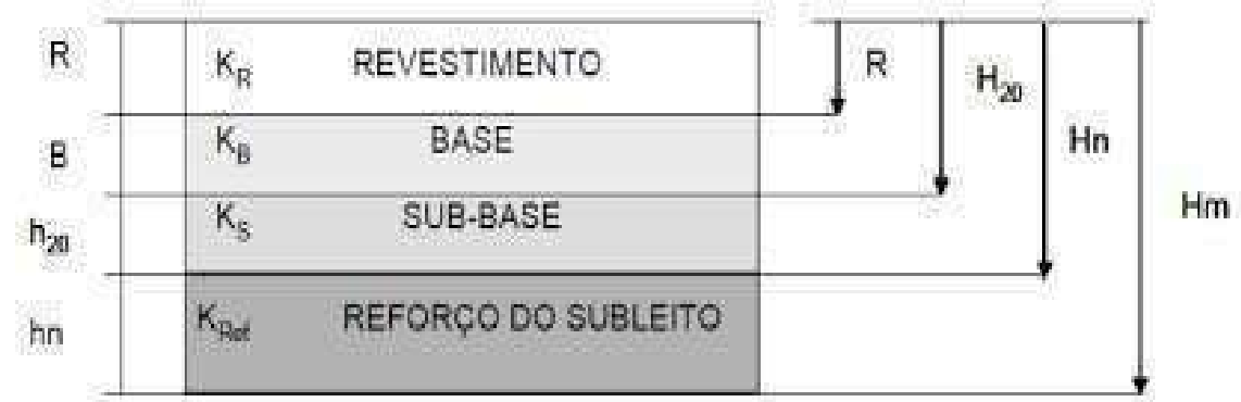
Figura 03. Dimensionamento de pavimento flexível
